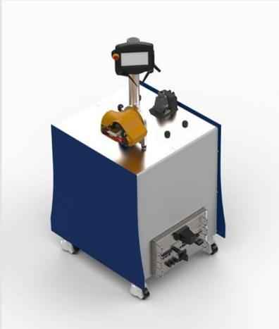
**Sur le bras :** Découverte générale de la mécanique du bras, des composants (pignon, courroie, système roue/vis, moteur brushless...) et différents principes (accouplements, transmissions...)
