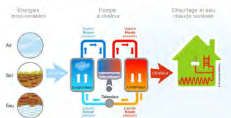
La pompe à chaleur, comment ça marche ?
